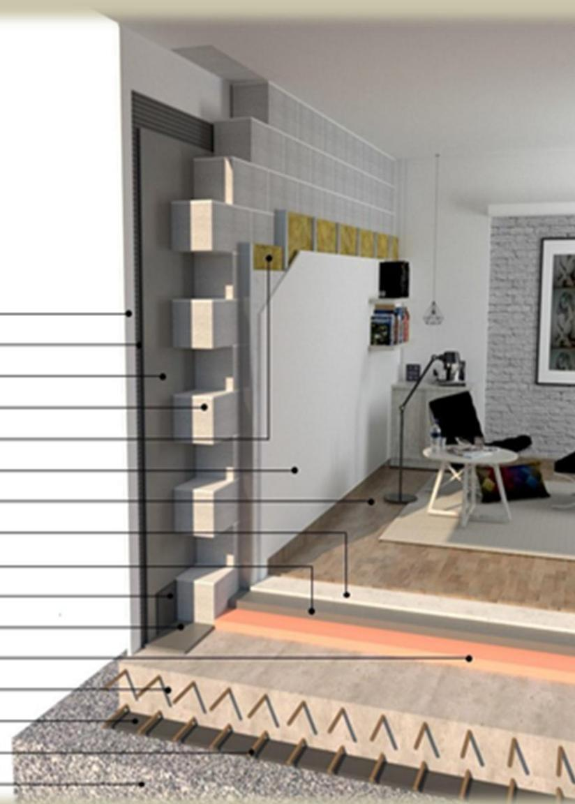
Sistema de construcción in situ con bloques de hormigón celular poroso y de baja densidad. La tradición mejorada.
